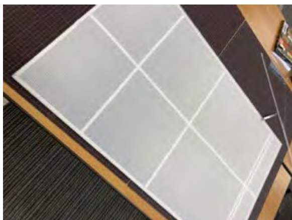
図9 反り防止の補強
